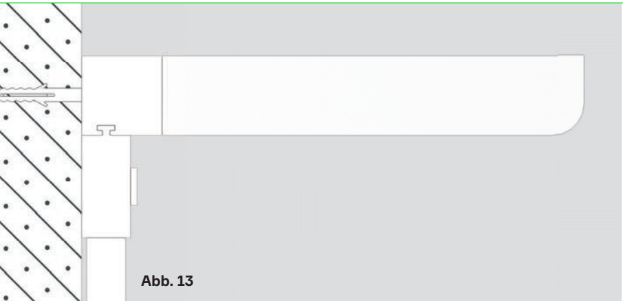
Wandmontage mit Wandprofil Der Wandkanal bietet die Möglichkeit, verschiedene Zubehörkomponenten aufzunehmen.
